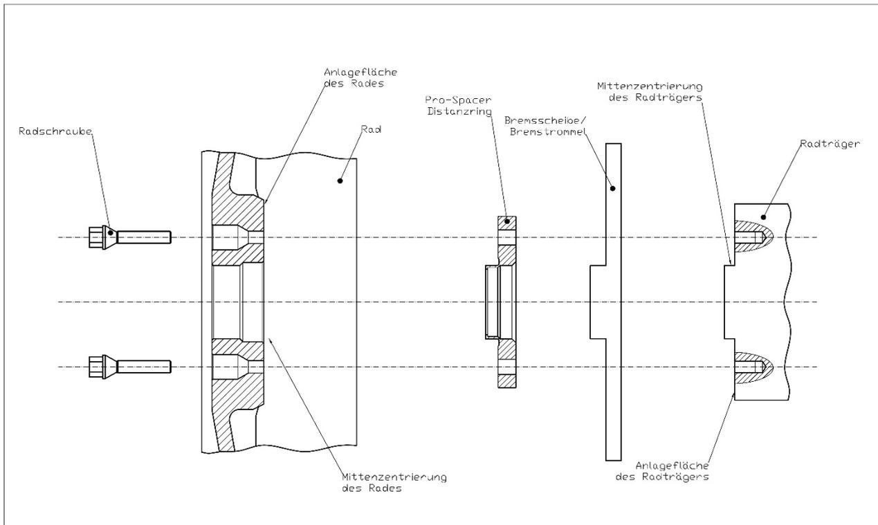
1. Die Mittenzentrierungen und Anlageflächen des Radträgers und des Rades (Bild 1) müssen von Rost und Schmutz befreit und gereinigt werden. Verwenden Sie hierzu eine Drahtbürste und gehen Sie vorsichtig vor um andere Bauteile nicht zu beschädigen.
